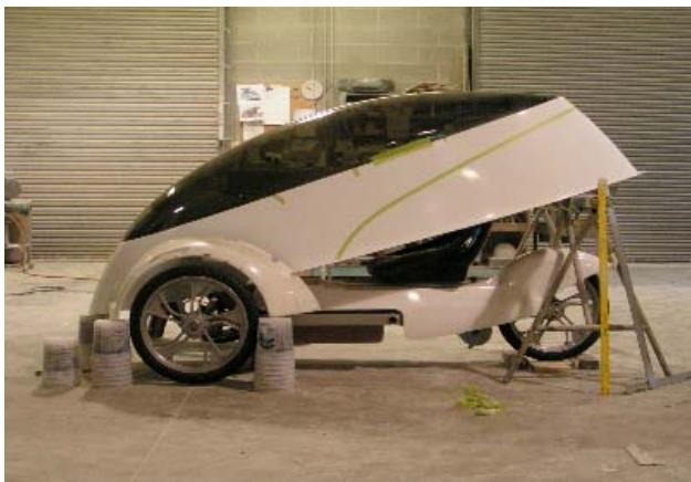
Ventilado es vera harda problemo en omna vehilo, precipue en mikra vehilo. Per seko la parto dopa di la lateri, la kabino permisus ventilado, e nur minim expozo di la pilotero.
