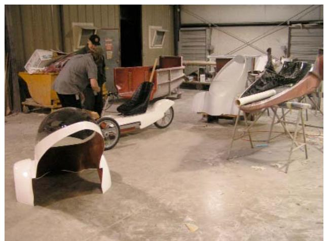
*Hike, vu povez vidar, senestre, la prototipo di la kabino, e dextre, la muldo di la kabino sur la tresti, ed en duesma plano, un kabino sen la bulo akrilika e la framo kun la panelo di la sidilo sur ol.*
